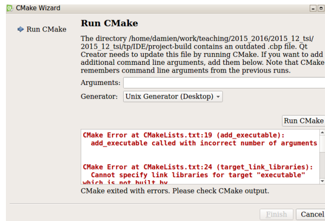
Figure 9: Exemple lors de l'exécution de Run CMake. Ici les chemins dans le CMakeLists.txt ne désignent aucun fichier source.
